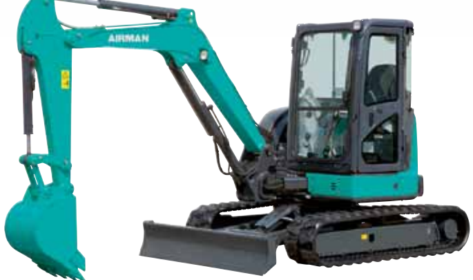
AX55u-6A Poids opérationnel 5,210kg Capacité 0.14m 3 Semelle en caoutchouc, cabine
