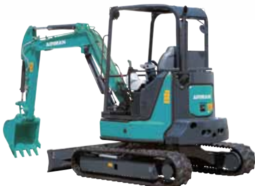
Poids opérationnel Capacité AX33u-6A 3,330kg 0,08m 3 Semelle en caoutchouc, toit à 4 supports
