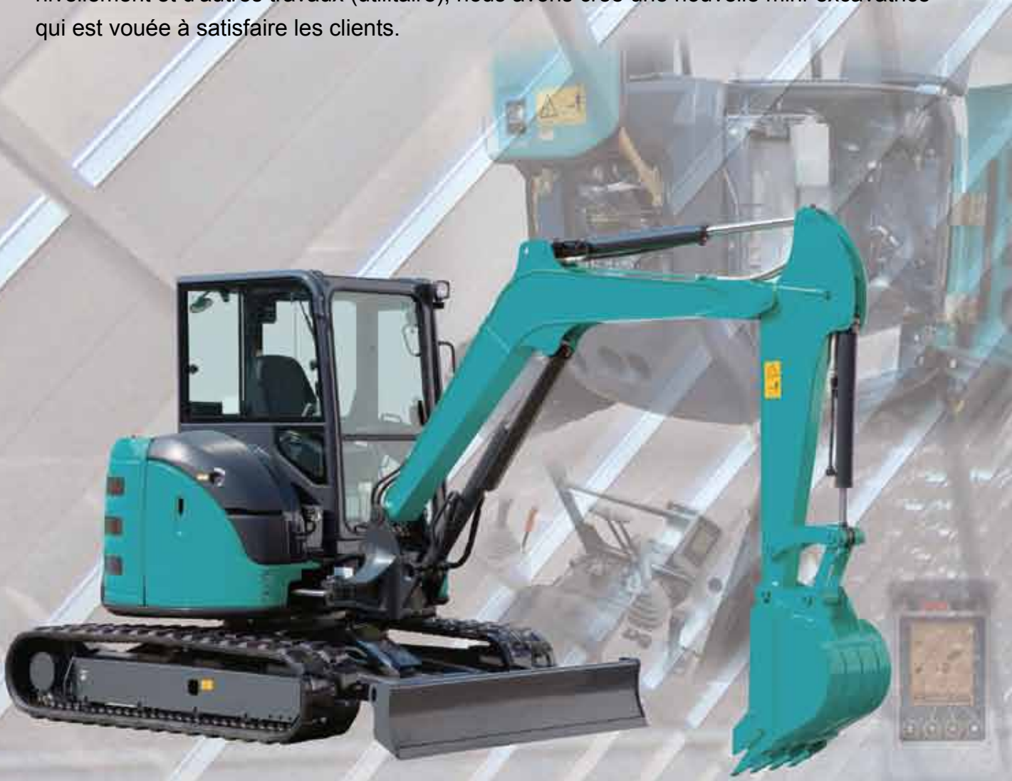
Poids opérationnel Capacité AX38u-6A 3,960kg 0,10m 3 Semelle en caoutchouc, cabine
