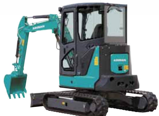
Poids opérationnel Capacité AX38u-6A 3,960kg 0,10m 3 Semelle en caoutchouc, cabine
