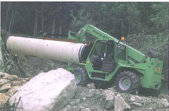
**Pinza per tubi in cemento con rotore**
